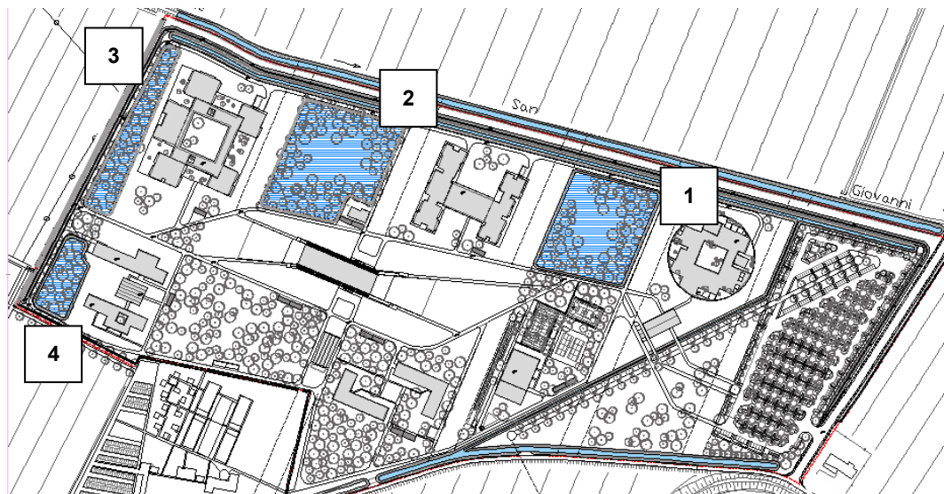
Figura 153 Schematizzazione del sistema di invaso previsto all'interno dell'ambito di intervento
