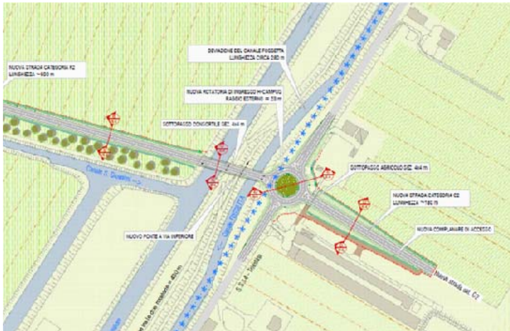
Figura 156 ipotesi progettuale di realizzazione della rotonda di spostamento del canale Fossetta.
